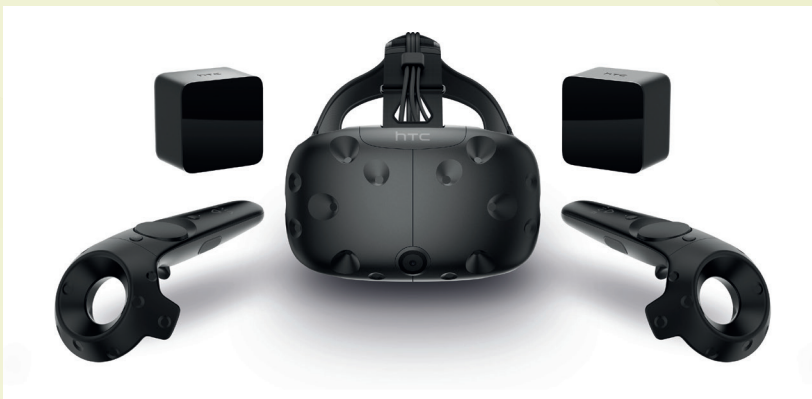
Abbildung 46: VR-Headset mit Controllern und Sensor-Boxen „HTC Vive“; Bildrechte: © 2011-2017 HTC Corporation, HTC Vive
